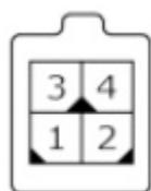
Рис.3. Внешний вид разъема Connect-Bus.
