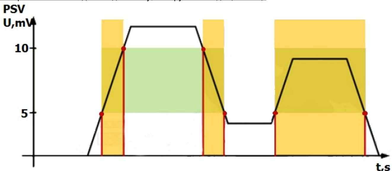
Рис.20. Генерація події щодо повернення/виходу в/з діапазону 3 - Моніторинг.
