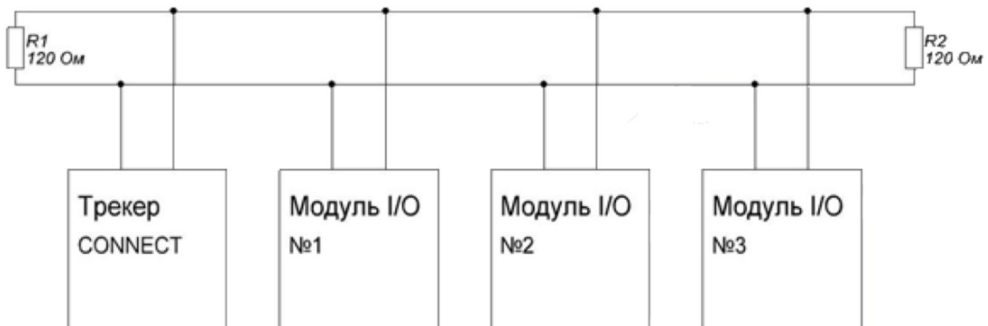
Рис.1 Топологія шини Connect-Bus
