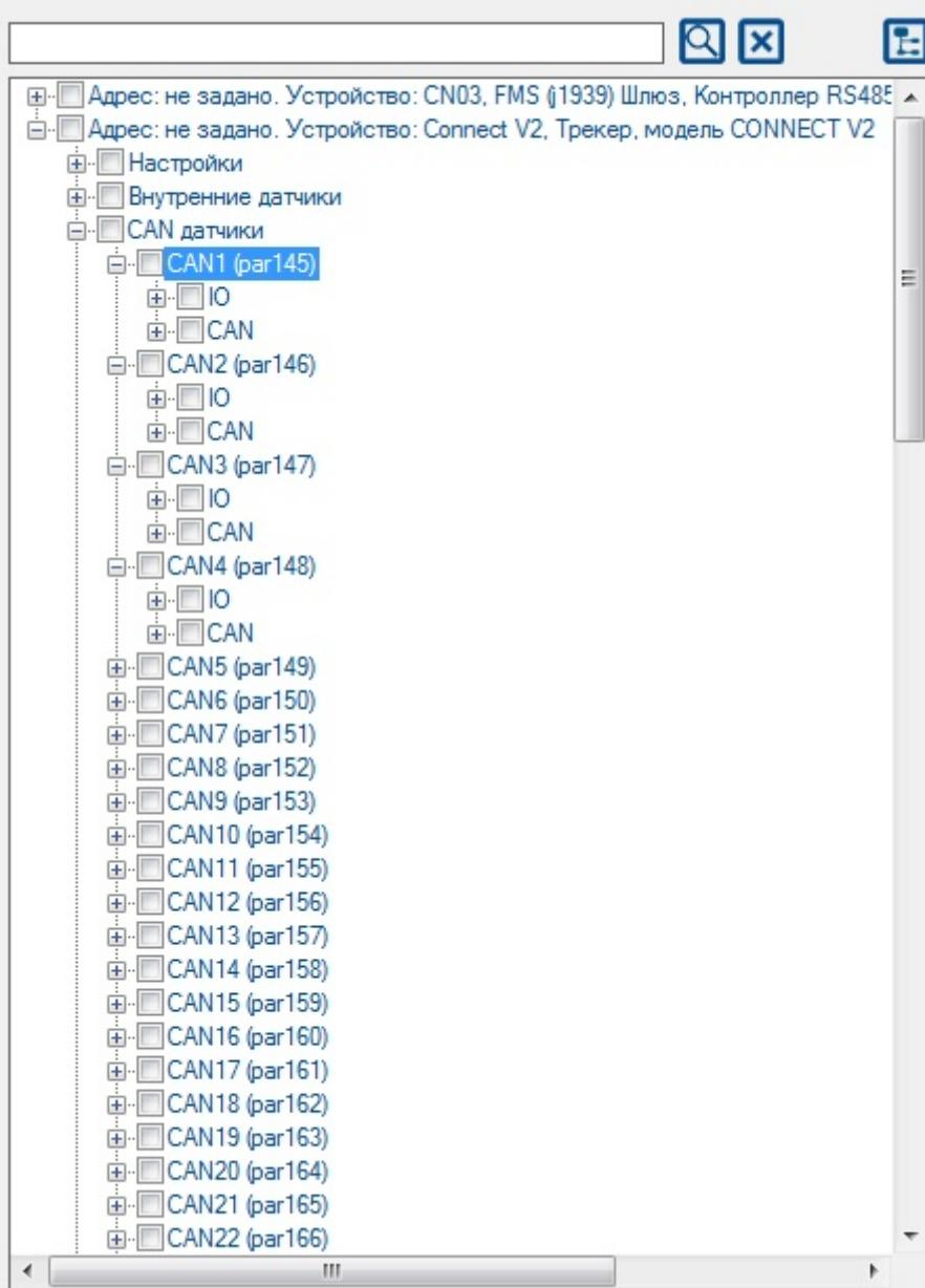
Рис.20. Структура змінних CAN-датчиків трекера
