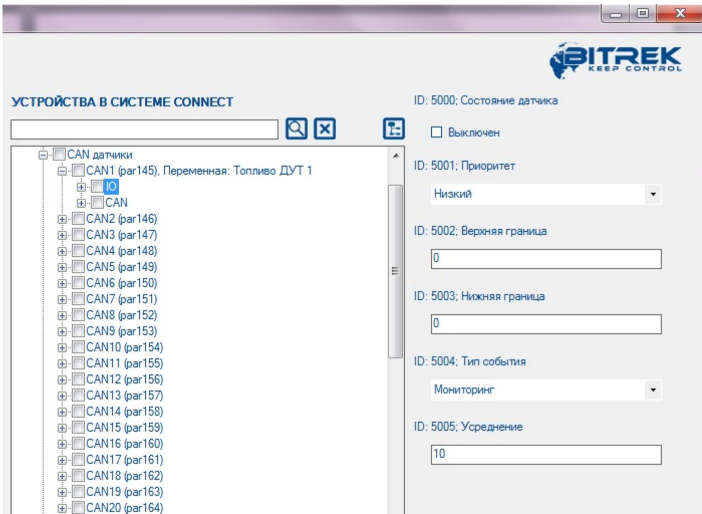
Рис.22. Налаштування параметрів I/O-підгрупи
