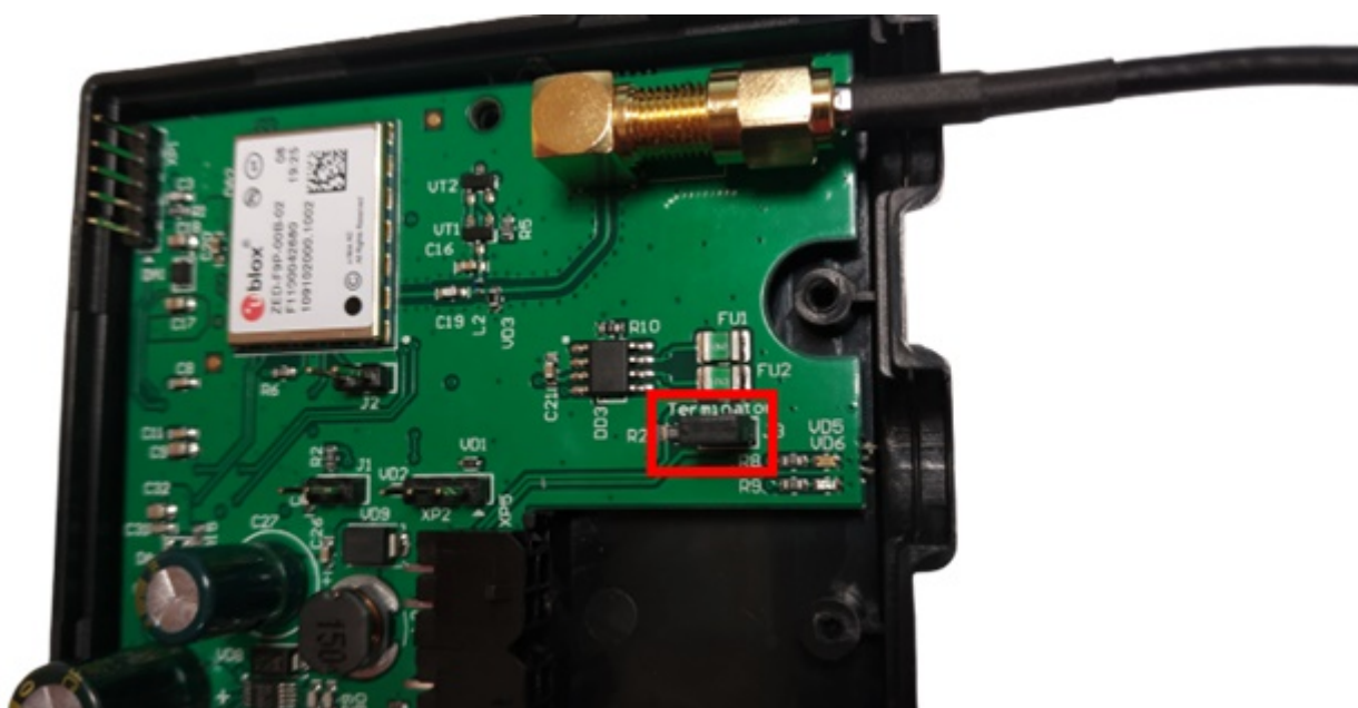
Рис.1. Джампер резисторної підтяжки 120 Ом
