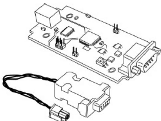
Рис.9. Внешний вид модуля конфигуратора
